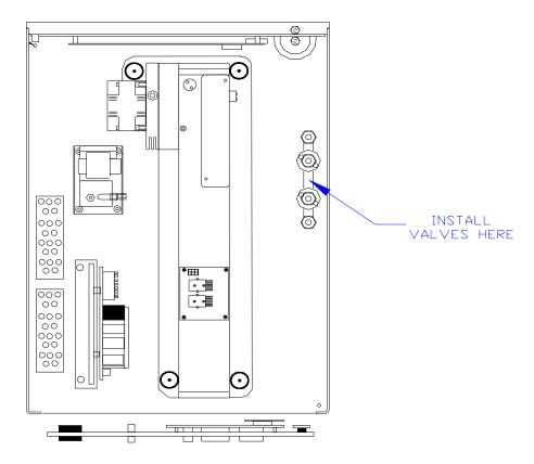
ZERO/SPAN VALVE RETROFIT FOR MODEL M300E
